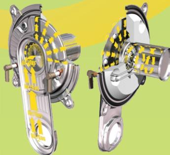
Atunci când se utilizează ARZĂTORUL CU CAPAC RECE, distribuția mixului aer/gaz pe toată suprafața capacului arzătorului, captează căldura transmisă de către combustie. Prin urmare, fluxul de intrare al mixului aer/gaz este agentul de răcire al arzătorului, și, mai mult decât atât, acest lucru permite ca amestecul aer/gaz să intre în arzător preîncălzit, optimizând astfel arderea.
